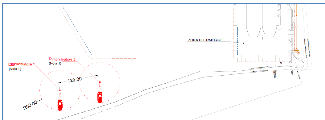
Figura 3.3.9: Disposizione punti di ormeggio prima del completamento della diga
