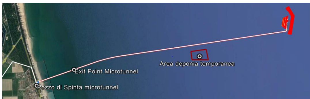
Figura 3.2.8 Inquadratura planimetrica area di immersione temporanea dei sedimenti provenienti dallo scavo dell'exit point del Microtunnel
