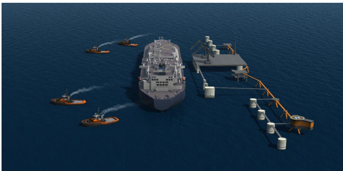
Figura 4.3.2 – Manovra di disormeggio della FSRU con l'ausilio di quattro rimorchiatori
