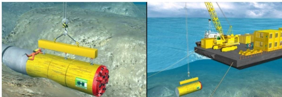
Figura 3.2.6 Schema indicativo di recupero della fresa di scavo nel punto di uscita a mare del microtunnel
